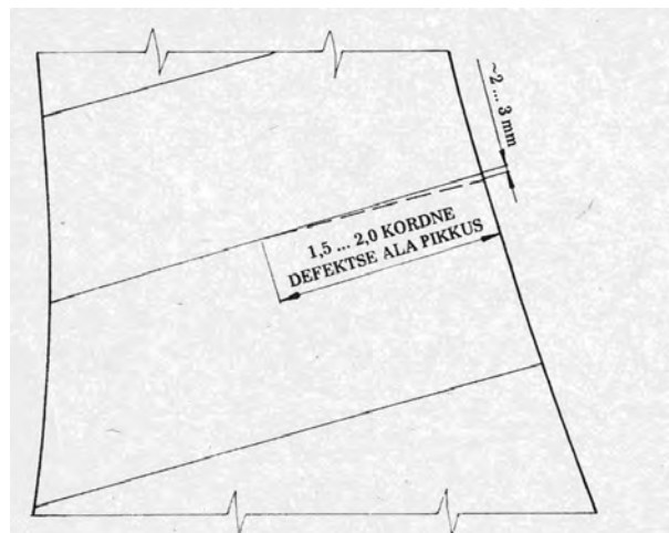
Joonis 4.36 Lõdva achterliigi korrigeerimine kiiludega
