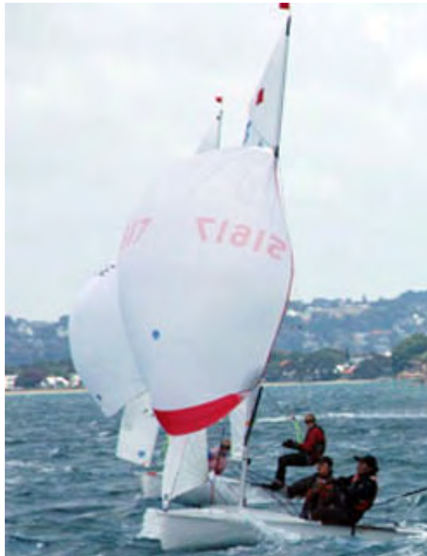
Joonis 7.64 Lainel liuglemine keskmises taganttuules
